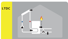
Solar com termóstato e retorno (aquec. auxiliar).
